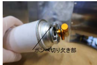
③アダプタの4つの爪の内一つだけボンベの切り欠き部に入るので合わせる。
