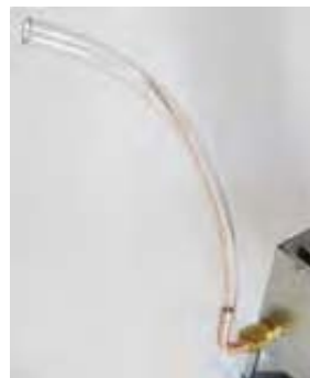
②透明ホースを持ち上げ銅線が出湯管の奥に届くように差し込み準備を終了します。
