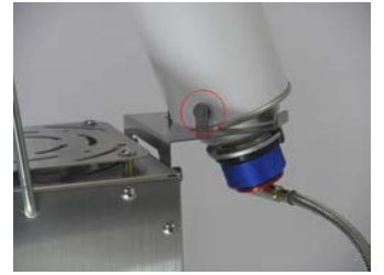
④スタンド付属の2個の強力マグネットにカセットボンベを斜めにしながら近づける
