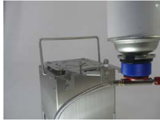
② OD-CB 変換アダプタをカセットボンベに取り付け専用スタンドに近付ける
