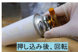
⑤押し込みをキープしつつアダプタを手で回転させる
