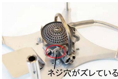
⑦外したバーナー本体をポリ hot 専用スタンドに仮載せします。Muka 吸気孔を写真の様に必ずスタンド正面右側に来るように SET してください。この時点ではネジ孔はズれています。
