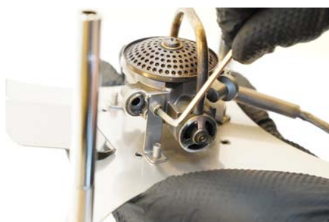
⑧ Muka 標準ネジを使用し、ポリ hot バーナースタンドステート Muka 取り付けネジ孔を合わせて付属の六角レンチで締めて行きます。
