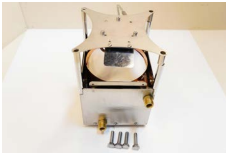
④写真のようにステンレスミラーが正面を向くようにバーナーベースプレートを置きます。
